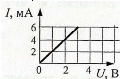
График зависимости силы тока в проводнике от напряжения между его концами
